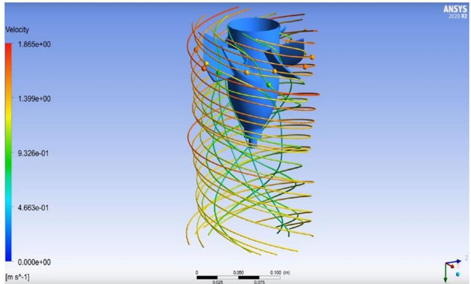
Die Wasserturbine von Ingenieure ohne Grenzen und die Wasserströmung um die Turbine werden mit den Simulationslösungen von Ansys berechnet und simuliert.
