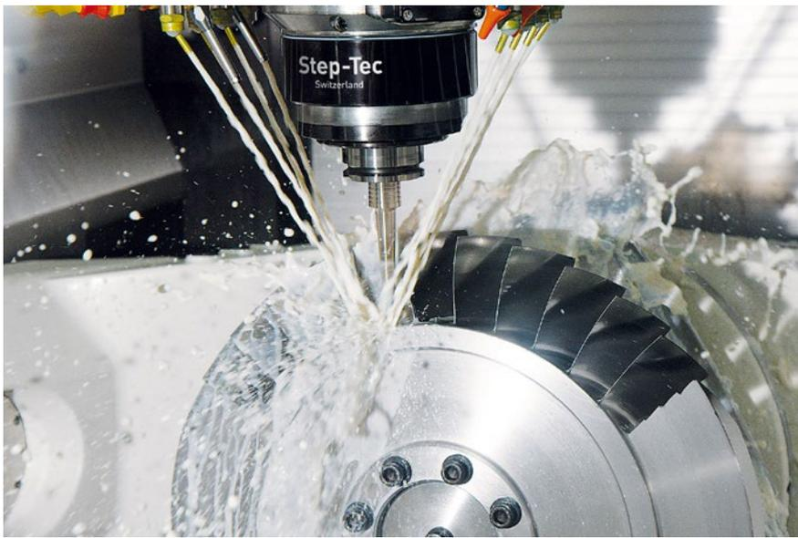
GF Machining Solutions liefert unter dem Markennamen Step-Tec Spindeln für Hochpräzisionsanwendungen. Entwickelt werden die Spindeln mit Creo, betreut wird das Schweizer Unternehmen von INNEO.
