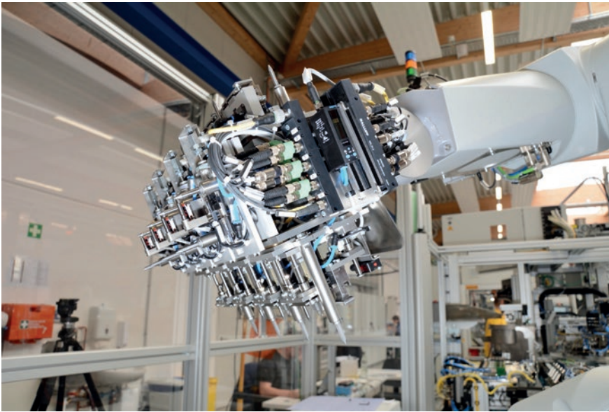
Greifer einer Spritzgussautomation zur Sensorherstellung bei XENON. Mit PTC Creo Elements/Direct lassen sich Anlagen wie die von XENON schnell und effizient konstruieren.
