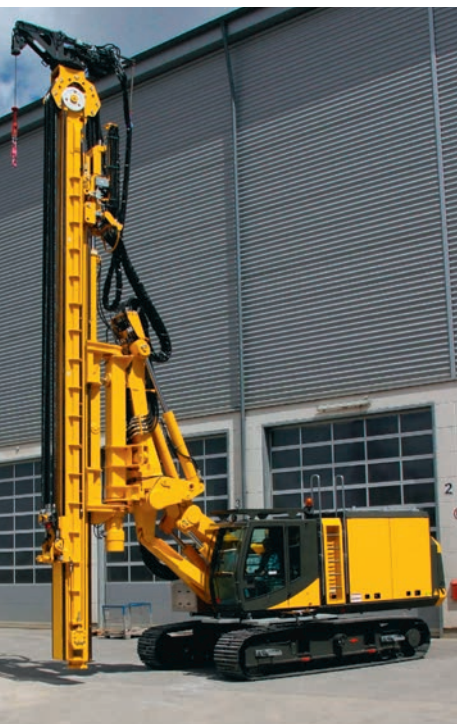
Die ABI-Maschinen, hier eine Mobilram TM 14/17V, werden teils auf zugekauften, teils auf eigenentwickelten Trägergeräten aufgebaut. (Bild: ABI)
