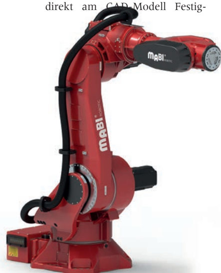
Mithilfe von Drehencodern in jedem Gelenk können die Mabi-Roboter das Werkzeug auch unter Last extrem genau positionieren.
